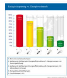
Vergleich des Energiesparpotenzials verschiedener Lampentypen [siehe Anhang 1, S. 5] Quelle: EC [siehe http://ec.europa.eu/energy/lumen/overview/whatchanges/index_de.htm ]
